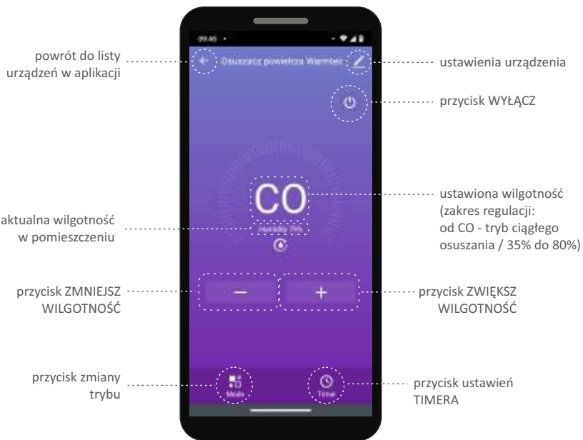
interfejs sterowania - urządzenie włączone (tryb osuszania + cyrkulacja)
